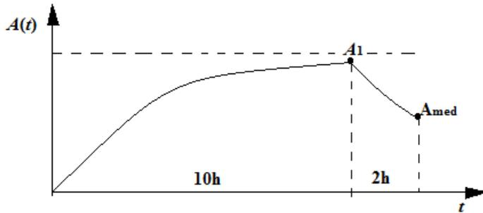
El conteo neto de 23000 cuentas/min provienen solamente de  $\text{Cu}^{64}$ , puesto que se conoce la eficiencia del detector se tiene que  $A_{med} = \frac{23000 \text{ c/min}}{.48} = 798.6 \text{ Bq}$
