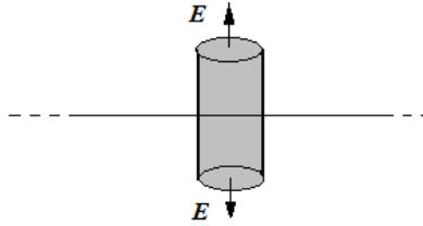
Aplicando la ley de Gauss sobre dicho volumen, solo las componentes de campo eléctrico perpendiculares al plano permanecen. El flujo de Campo eléctrico a través de la superficie cerrada es igual a la carga encerrada dentro del Volumen. Así.
